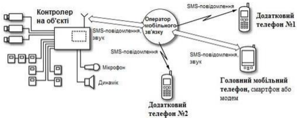
Рисунок 1.1 – Схема передавання SMS повідомлень в GSM
