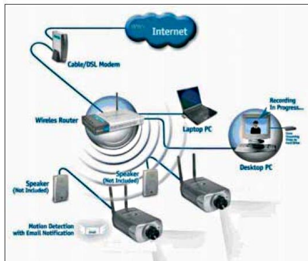
Рисунок 1.2 – Схема побудови відео – системи за шляхом WI-FI
